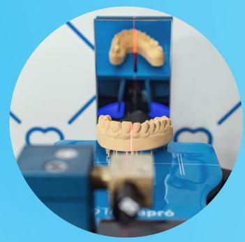
O espelho reflete o laser e permite a visualização simultânea do modelo em 180°, possibilitando 100% de previsibilidade no corte.
